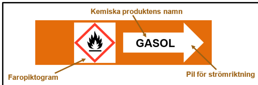
Figur 19: Synliga rörledningar som innehåller gas eller vätska ska märkas med den kemiska produktens namn, faropiktogram samt pil för strömriktning. Färgmarkeringen på etiketterna ska följa svensk standard (SS 741). Exemplet i bilden visar en rektangulär orange etikett för den brandfarliga gasen gasol. Etiketten är märkt med den kemiska produktens namn "gasol", en pil för strömriktning till höger samt faropiktogram för brandfarligt.
