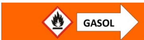
Figur 8 Exempel på märkning av rörledning för gasol.
