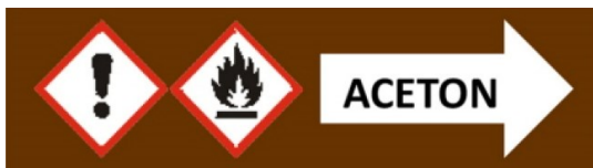
Figur 7 Exempel på märkning av rörledning för aceton
