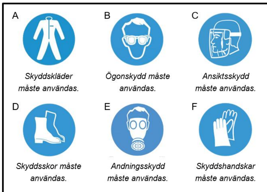
Figur 5: Exempel på påbudsskyltar. (A) Skyddskläder måste användas, (B) Ögonskydd måste användas, (C) Ansiktsskydd måste användas, (D) Skyddsskor måste användas, (E) Andningsskydd måste användas och (F) Skyddshandskar måste användas.
